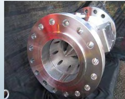
ProDry (séchage du gaz)
